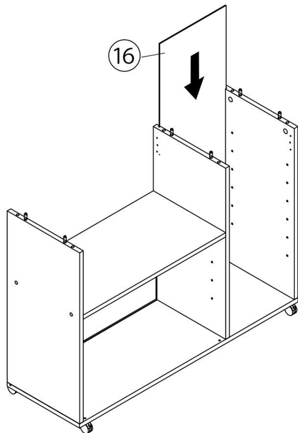
8 ステップ7にステップ2を図のように取り付けH専用ネジで固定します。
