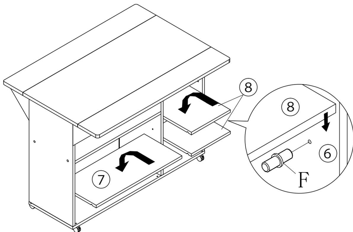
**10** ステップ8にB.カムロック(受け)を取り付け、ステップ9を差し込みカムロック(受け)を絞めます。その際、ステップ9の部材①が図のように正面になるよう注意してください。
