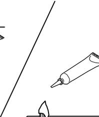
ダボに直接ボンドを垂らし、穴の部分をかぶせて取り付ける。
