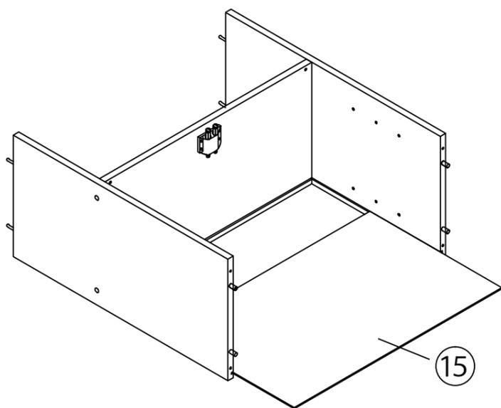
6 ステップ1のダボ穴にK.ボンドを図のように垂らし、吹き出しの図のように溝位置に注意し、ステップ5と⑥右側板を取り付け、A.ネジで固定します。
