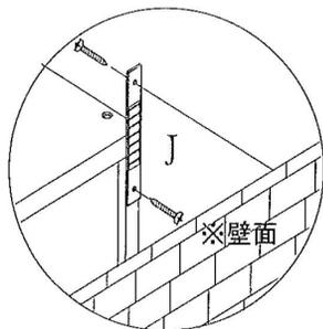
壁際に設置する際は、転倒防止にJ:転倒防止用プレートを本体と壁面に図のように取り付けてください。※壁用のネジは、壁の材質に合ったものをご利用ください。
