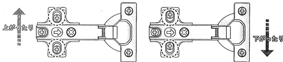
左右の扉の高さが違う場合は、この「高さ調節ネジ」を少しゆるめて扉の上下の位置を調整し、丁度いい高さのところまで改めてネジを締め付けて下さい。
