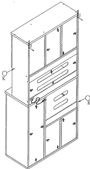
※背面の隙間に差込み、専用ネジで固定します。
