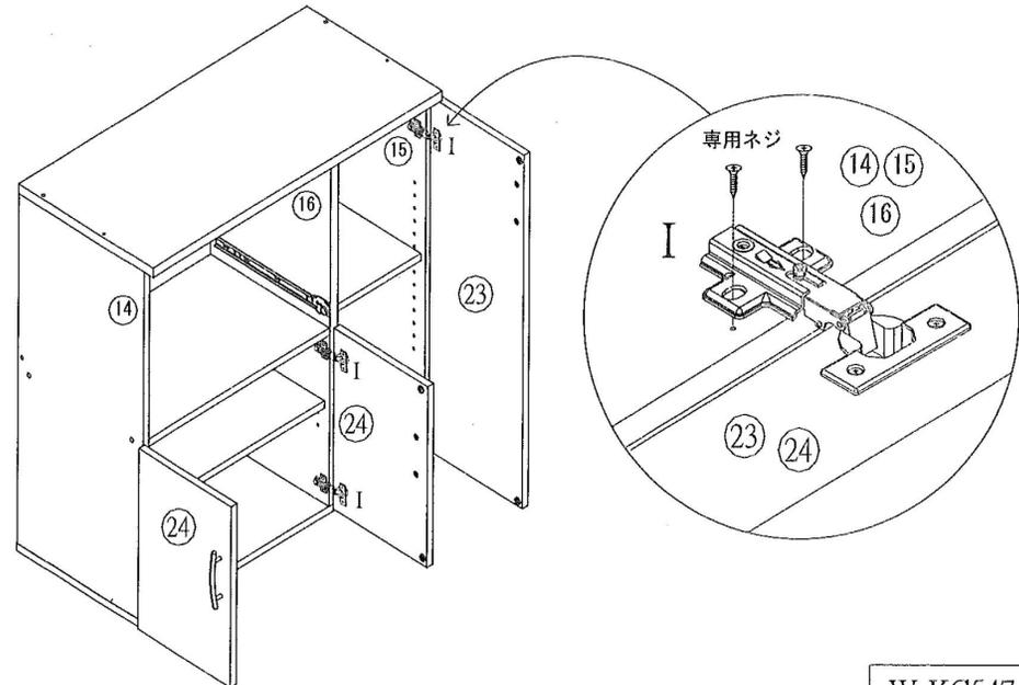
20 STEP13で組み立てたスライドトレーを取り付けて、本体の下半分が完成です。
