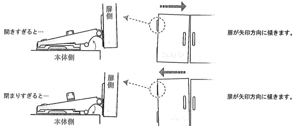
ヒンジは通常上下2つで1セットなので、「角度調節ネジ」を回すときは、上下のヒンジを合わせる必要があります。片方だけ角度が違えば扉の傾きの原因になりますので、扉の傾きが気になる時は、ネジの回転数(1回転、2回転…)を上下であわせて、ヒンジの角度を同じにしてあげる事で、扉をまっすぐ取り付けることができます。
